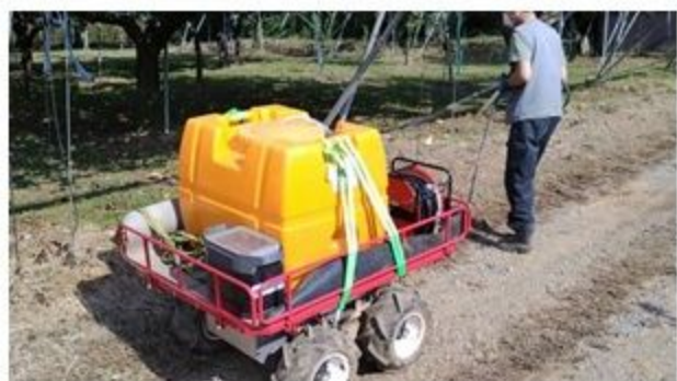
噴霧用のタンク・ホース・ポンプ・電源を運搬し追従
