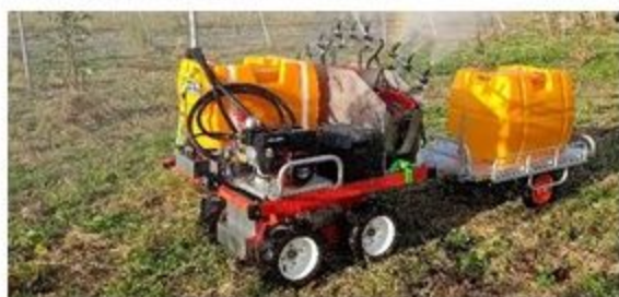
薬液散布機を搭載し、薬液タンクを牽引
